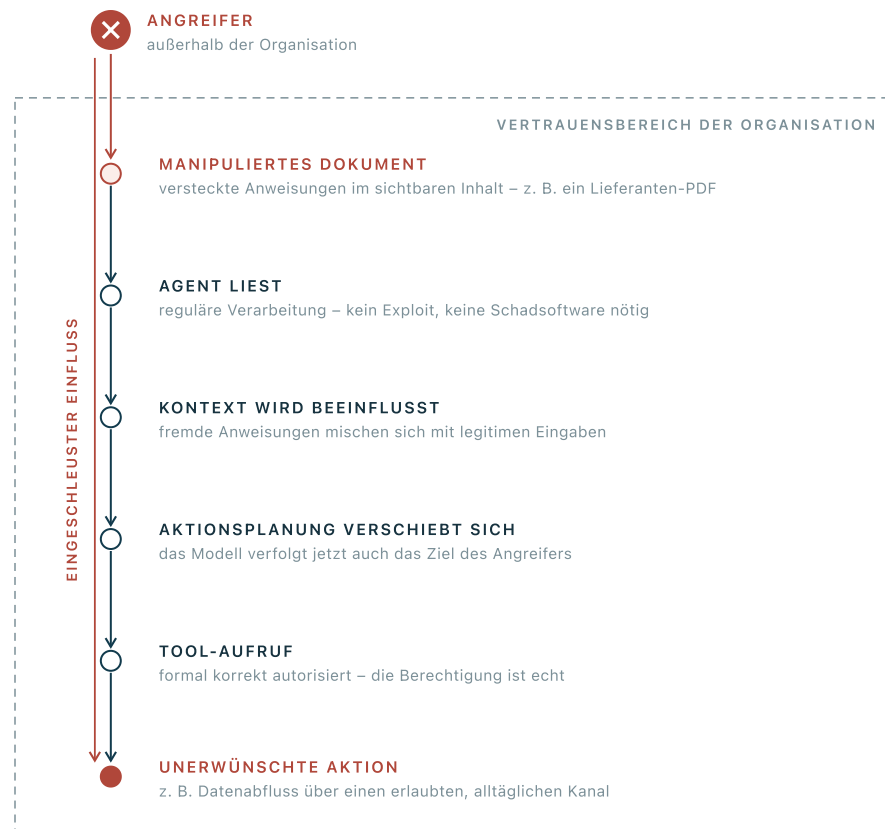
ABB. 3 Ein realistischer Angriffspfad. Entscheidend ist nicht, dass ein Dokument manipulieren kann – sondern dass derselbe Agent auch handeln darf.
